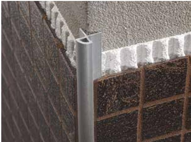
Profilo brevettato jolly dall'innovativo concetto produttivo ad "X" per un migliore fissaggio meccanico delle tessere in mosaico vetroso. Idoneo alla protezione degli spigoli e dei gradini, evidenzia una parte a vista arrotondata e simmetrica. L'altezza fissa a 4,4 mm lo rende ideale per la posa dei classici mosaici vetrosi.
